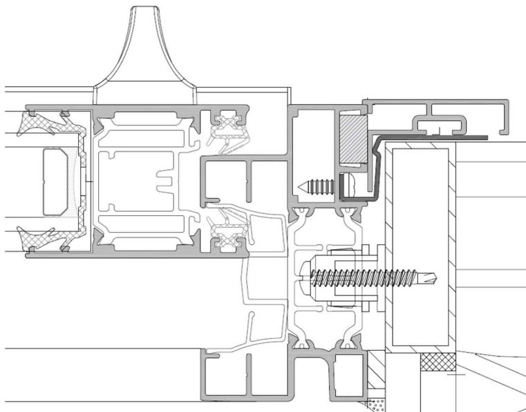
Grapas metálicas para clipar y desclipar el tapajuntas de ventanas y puertas de forma rápida y con la misma apariencia y prestaciones que las fijadas mecánicamente.
